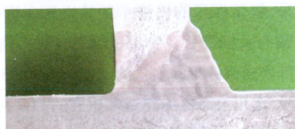
图4 试样2-1 (T形熔透)
